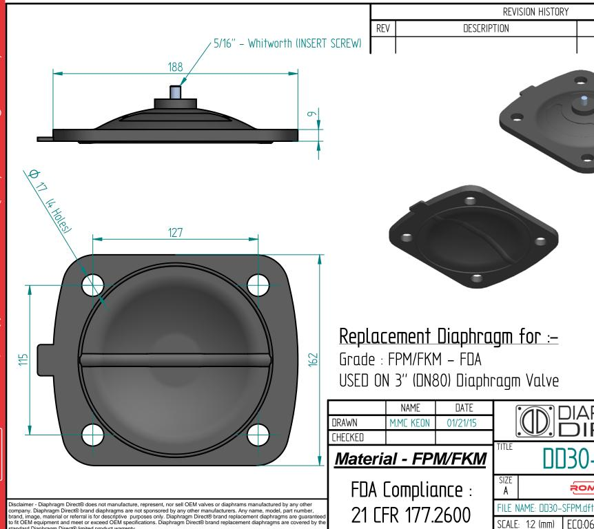
**REVISION HISTORY** DATE **APPROVED** Scale 1:3.33 Replacement Diaphragm for :-USED ON 3" (DN80) Diaphragm Valve DD30-SFPM
